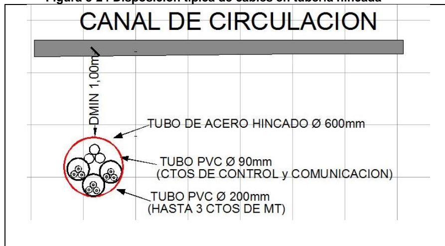
Figura 3-24 Disposición típica de cables en tubería hincada
