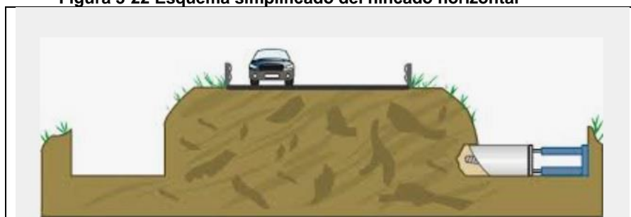
Figura 3-22 Esquema simplificado del hincado horizontal
